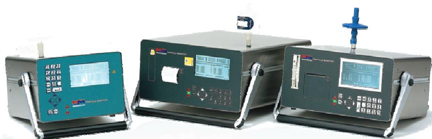
Mit den optischen Partikelmesszählern der Modellreihe LS lassen sich Messungen im Bereich von 0,1 - 10 µm gemäß nationalen und internationalen Standards ISO 14644-1, VDI 2083 und DIN 1946-4 ausführen. Durch den kompakten und leichtgewichtigen Aufbau der Geräte eignen sie sich sowohl für den stationären wie auch mobilen Einsatz.
